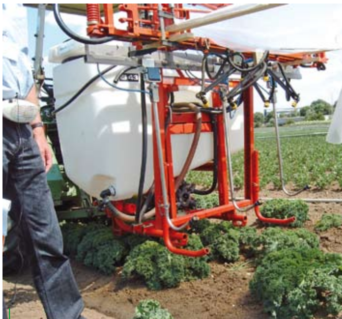
Bekämpfung der Kohlmottenschildlaus bei Grünkohl mit der Unterblatt-Spritztechnik Dropleg-FK
